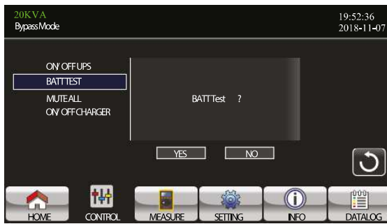
Prueba de batería
